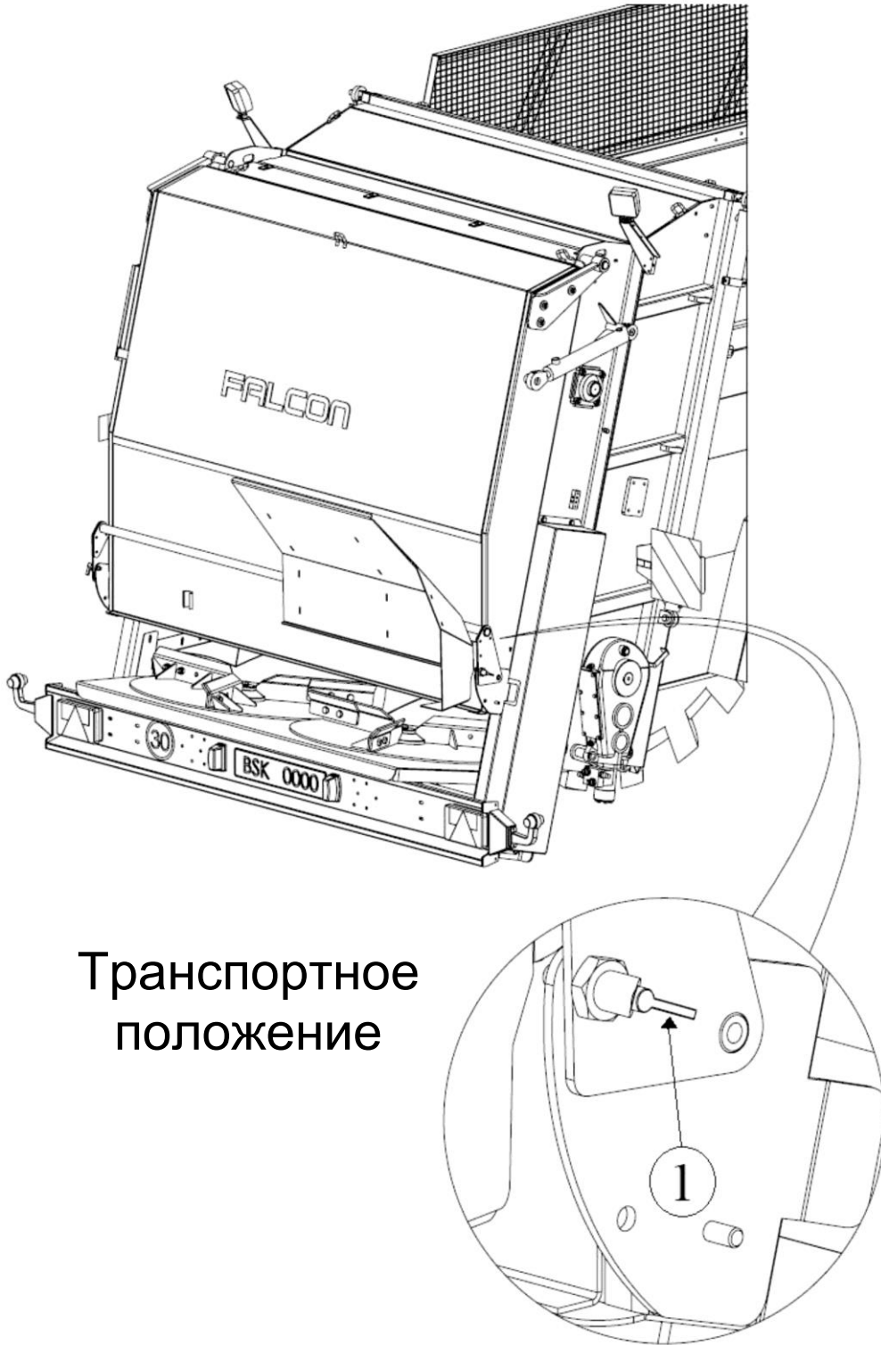
Рисунок 28. Дефлектор горизонтального адаптера в транспортном положении
