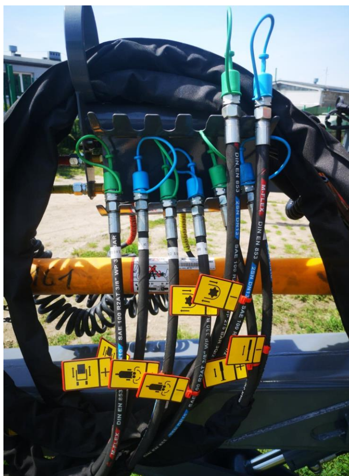
Рисунок 22. Пиктограммы на разъемах гидравлических линий для облегчения подключения линии к трактору (стандарт)
