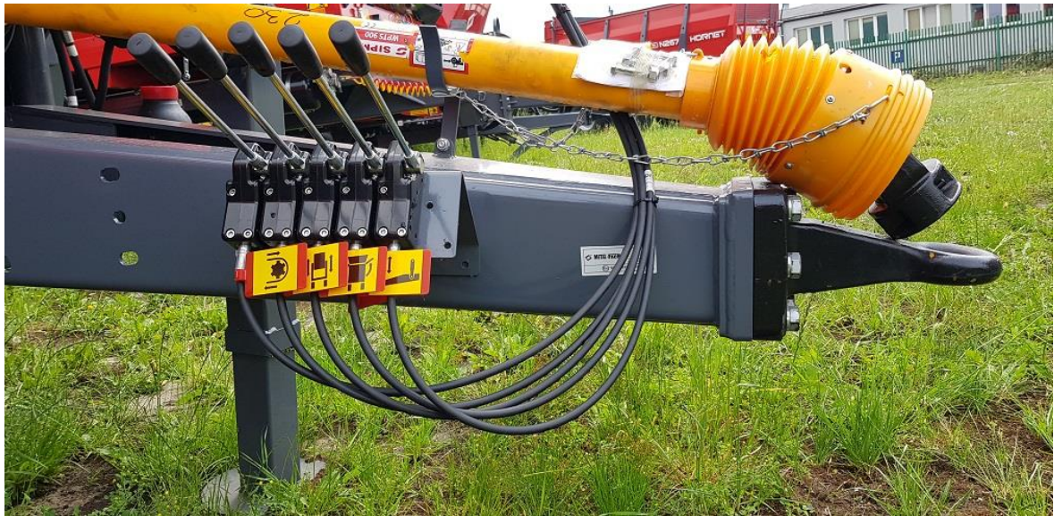
Рисунок 23. Пиктограммы, обозначающие рычаги управления распределителем (управление распределителем предлагается в качестве опции)
