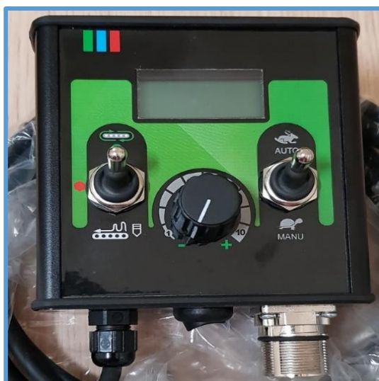
Рисунок 26. Панель управления для регулировки скорости перемещения напольного конвейера с помощью потенциометра - ручки управления (дополнительное оснащение).
