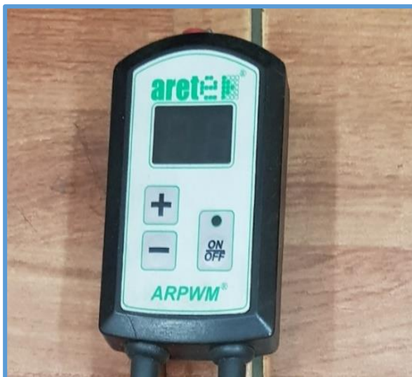
Рисунок 25. Панель управления для регулировки скорости перемещения напольного конвейера с кнопками "+/-" (дополнительное оснащение).
