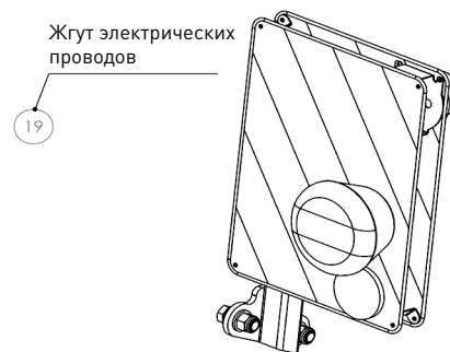
Световая сигнализация культиватора U-740 21.00.00
