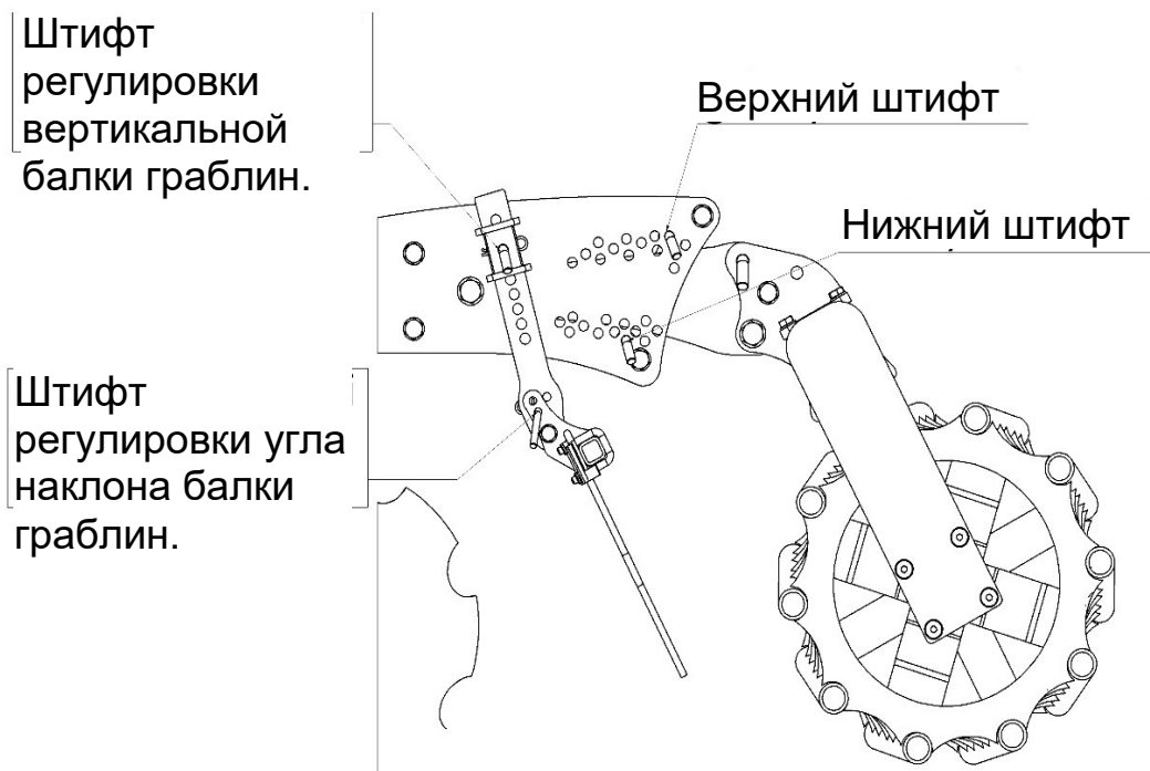
Рис. 20. Регулировка глубины работы
