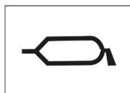
Rysunek 25. Oznaczenie miejsc smarowania prasy
