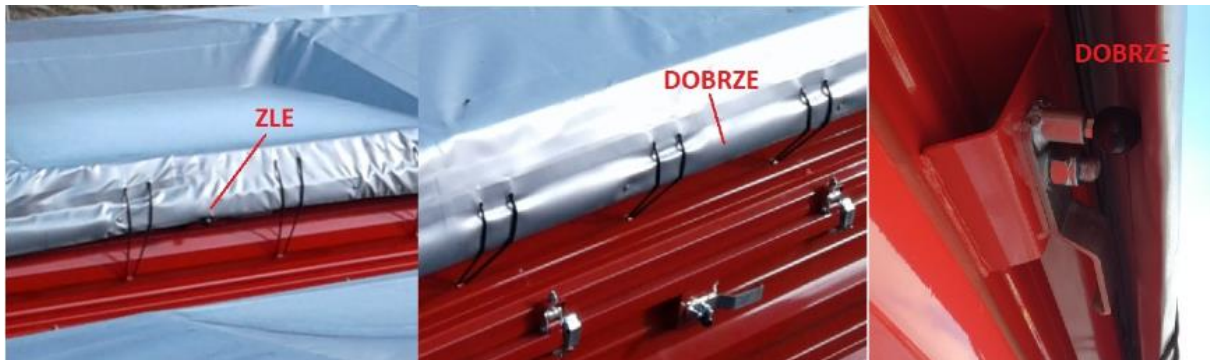
Rysunek 4. Prawidłowy naciąg plandeki
