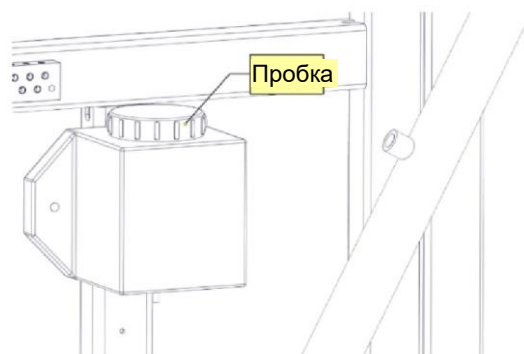
Рисунок 32. Масляный бак в системе автоматической смазки цепей
