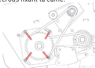
Fig. 33. Réglage de la came du pick-up.
