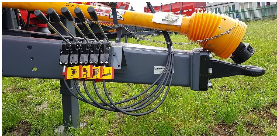
Rysunek 22. Oznaczenie piktogramami dźwigni sterujących rozdzielaczem (sterowanie rozdzielaczem występuje jako opcja)
