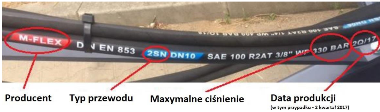
Rysunek 20. Oznaczenia przewodów hydraulicznych
