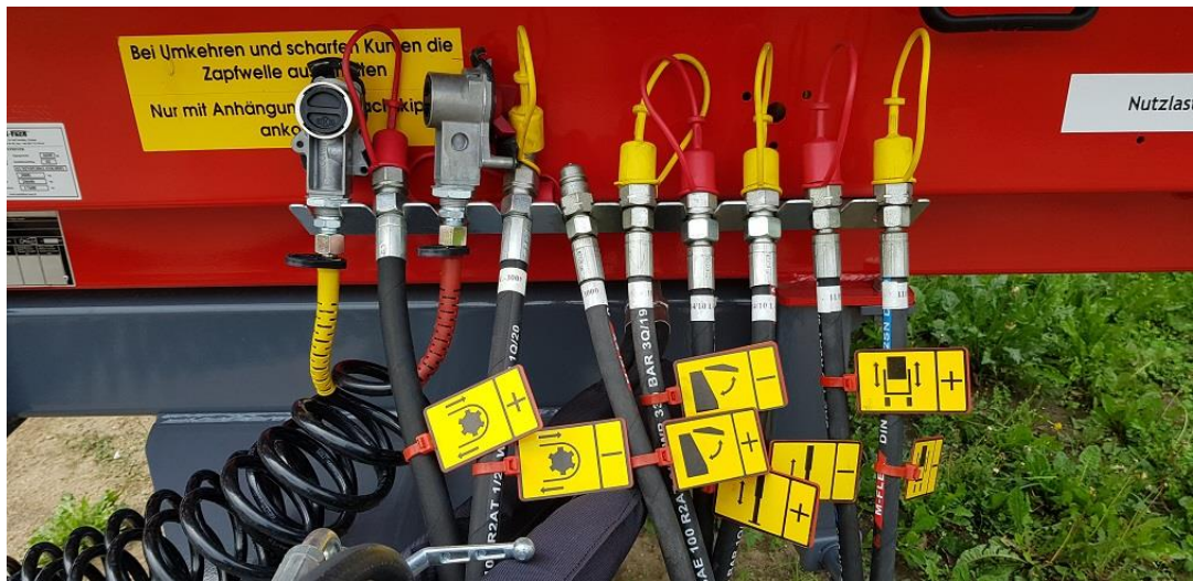
Rysunek 21. Oznaczenie złączy przewodów hydraulicznych piktogramami ułatwiającymi podłączenie przewodu do ciągnika
