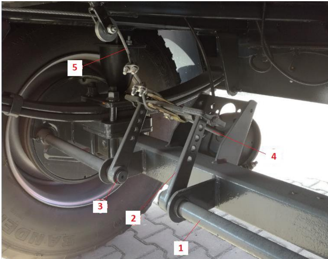
Abbildung 20. Bestandteile der Bremsanlage (1 - Backennockenwelle, 2 - Hebel (Tragarm) der Nockenwelle, 3 - Einstellkamm des Armes auf der Nockenwelle, 4 - Zugstab (Stößel), der die Kolbenstange des Pneumatikzylinders mit dem Nockenwellenarm verbindet, 5 - Feststellbremsseil)
