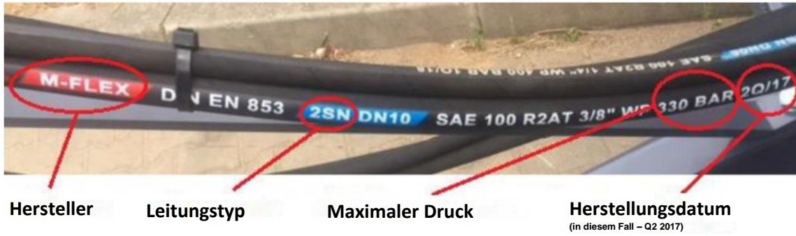
Abbildung 21. Kennzeichnung von Hydraulikschläuchen
