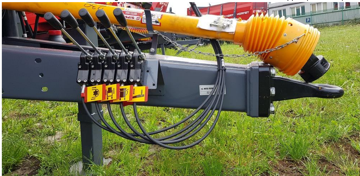
Abbildung 22. Kennzeichnung der Anschlüsse von Hydraulikschläuchen zur Erleichterung des Anschlusses der Schläuche an den Schlepper (Standard)
