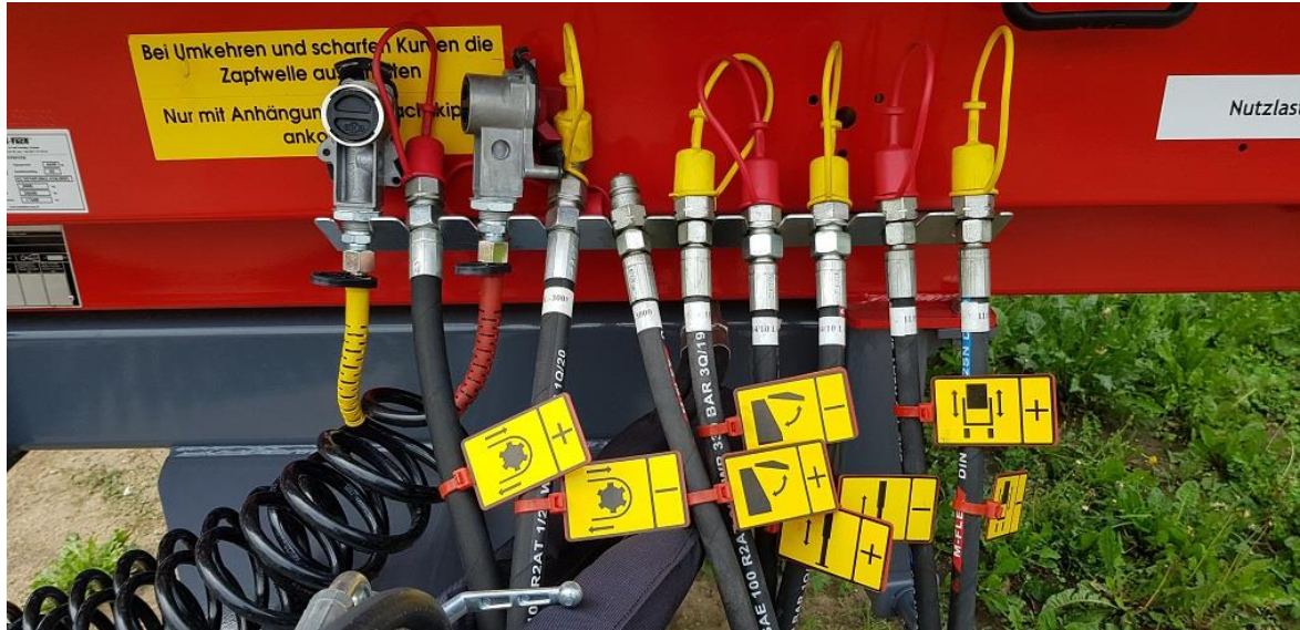
Abbildung 21. Kennzeichnung von Hydraulikschläuchen
