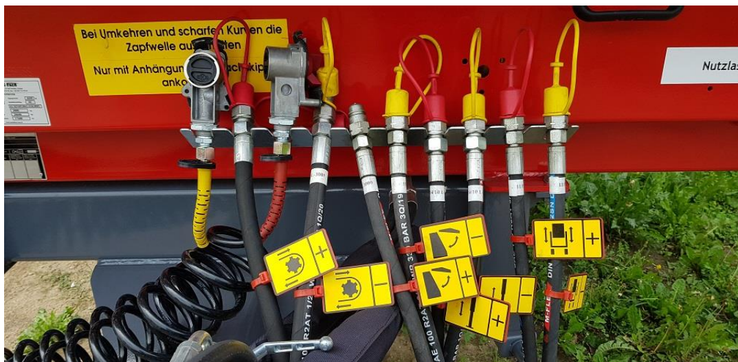
Abbildung 21. Kennzeichnung der Anschlüsse von Hydraulikschläuchen zur Erleichterung des Anschlusses der Schläuche an den Schlepper
