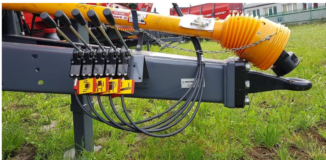
Abbildung 22. Kennzeichnung der Steuerhebel des Verteilers mit Piktogrammen (eine Steuerung des Verteilers ist optional erhältlich)
