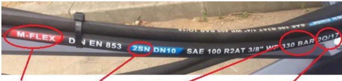
Производитель Тип шланга Максимальное давление Дата изготовления (в данном случае - 2 квартал 2017 года)
