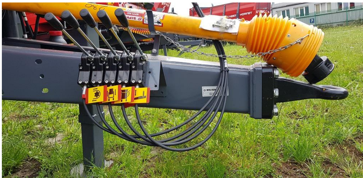
Рисунок 23. Маркировка рычагов управления навозоразбрасывателя (управление навозоразбрасывателем является опцией)
