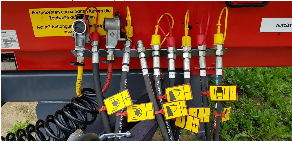
Рисунок 22. Маркировка разъемов на гидравлических шлангах для облегчения подсоединения шланга к трактору (стандарт)
