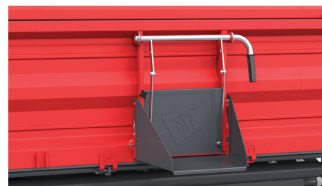
Szyber z rywną - daje możliwość precyzyjnej regulacji przepływu materiałów, co umożliwia łatwe i efektywne rozładunek zbiorów
