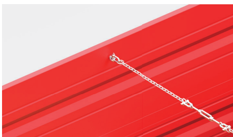
Łańcuch spinający - usztywnia ściany przestrzeni ładunkowej
