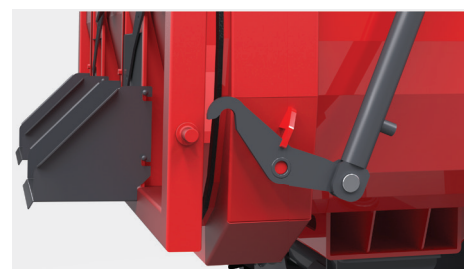
Tylna kłapa otwierana hydraulicznie - standardowo zamki hydrauliczne kłapy tylnej
