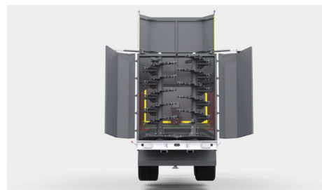
Możliwość zmiany przyczepy w rozrzutnik po zamontowaniu adaptera pionowego
