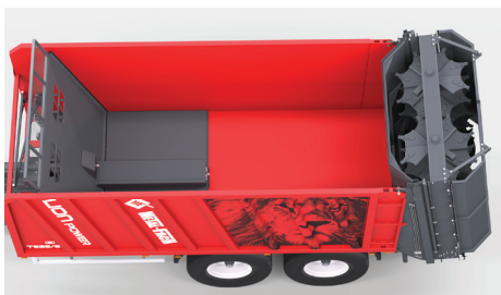
Możliwość zmiany przyczepy w rozrzutnik po zamontowaniu adaptera poziomego
