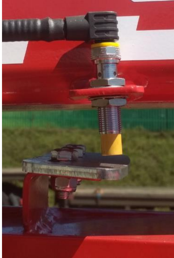
Рисунок 22. Настройка индуктивного датчика оборотов
