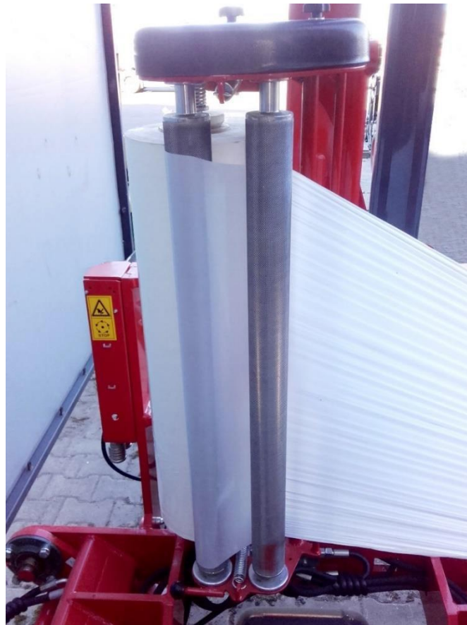
Рисунок 33. Правильное расположение пленки в подающем механизме
