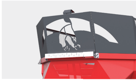
Wskaźnik położenia zasuw - umożliwia precyzyjną kontrolę nad ustawieniem zasuw, co zwiększa efektywność pracy
