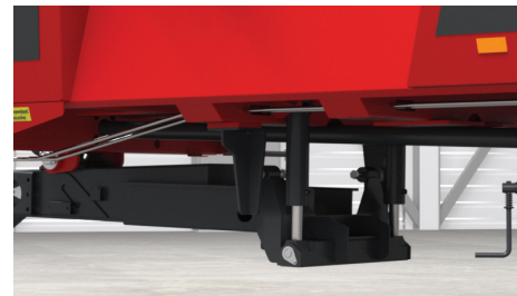
Dyszel amortyzowany hydraulicznie
