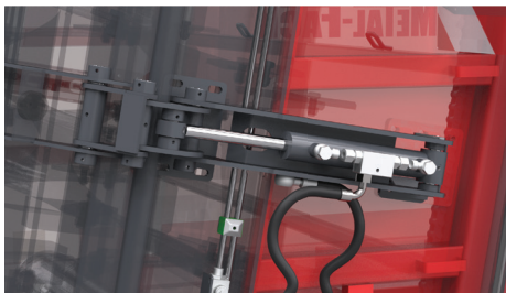
Podwójny przegub otwierania kłapy tylnej - pozwala na hydrauliczne otwieranie kłapy do 180 stopni - opcja
