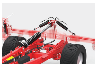
Hydrauliczna regulacja pracy poprzez nośnik U910
