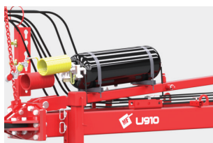
Hamulec pneumatyczny dwuobwodowy / hydrauliczny
