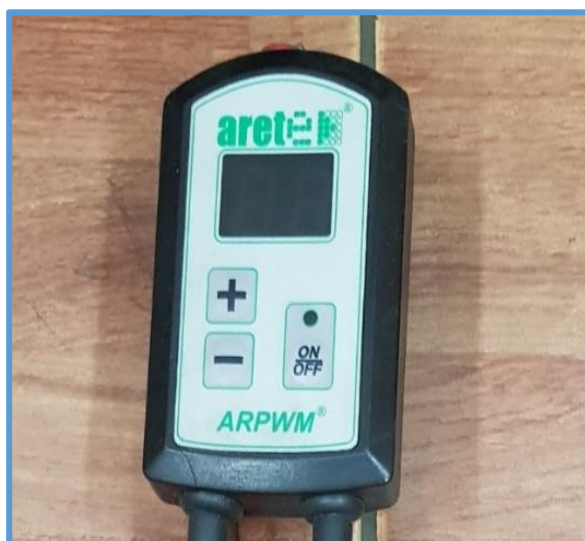
Rysunek 25. Panel sterujący regulacją prędkości przesuwu przenośnika podłogowego za pomocą przycisków „+/-”, (wyposażenie opcjonalne).
