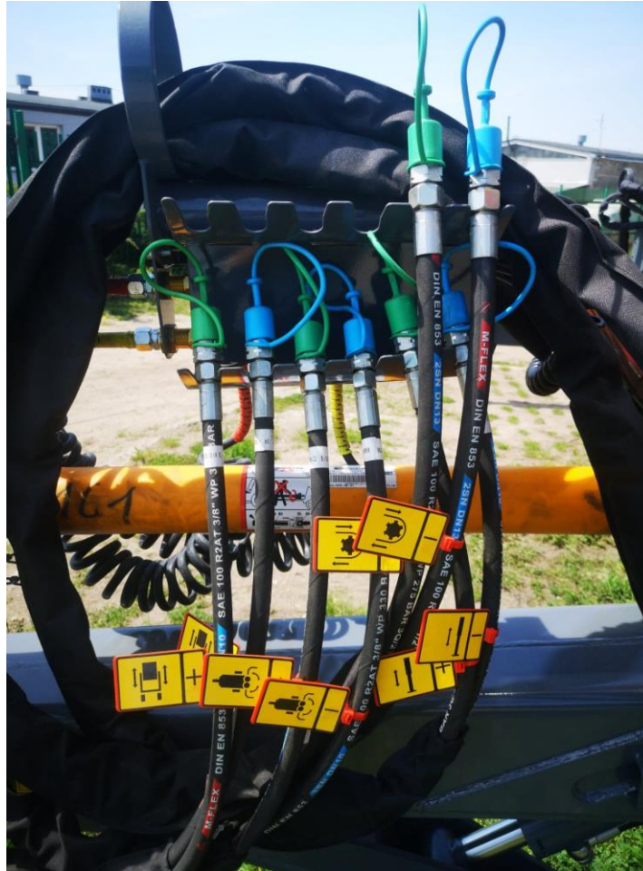
Rysunek 22. Oznaczenie złączy przewodów hydraulicznych piktogramami ułatwiającymi podłączenie przewodu do ciągnika (standard)
