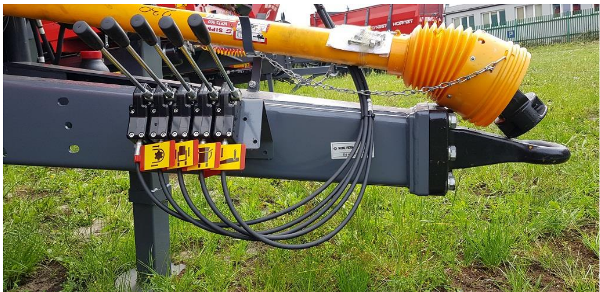
Rysunek 23. Oznaczenie piktogramami dźwigni sterujących rozdzielaczem (sterowanie rozdzielaczem występuje jako opcja)
