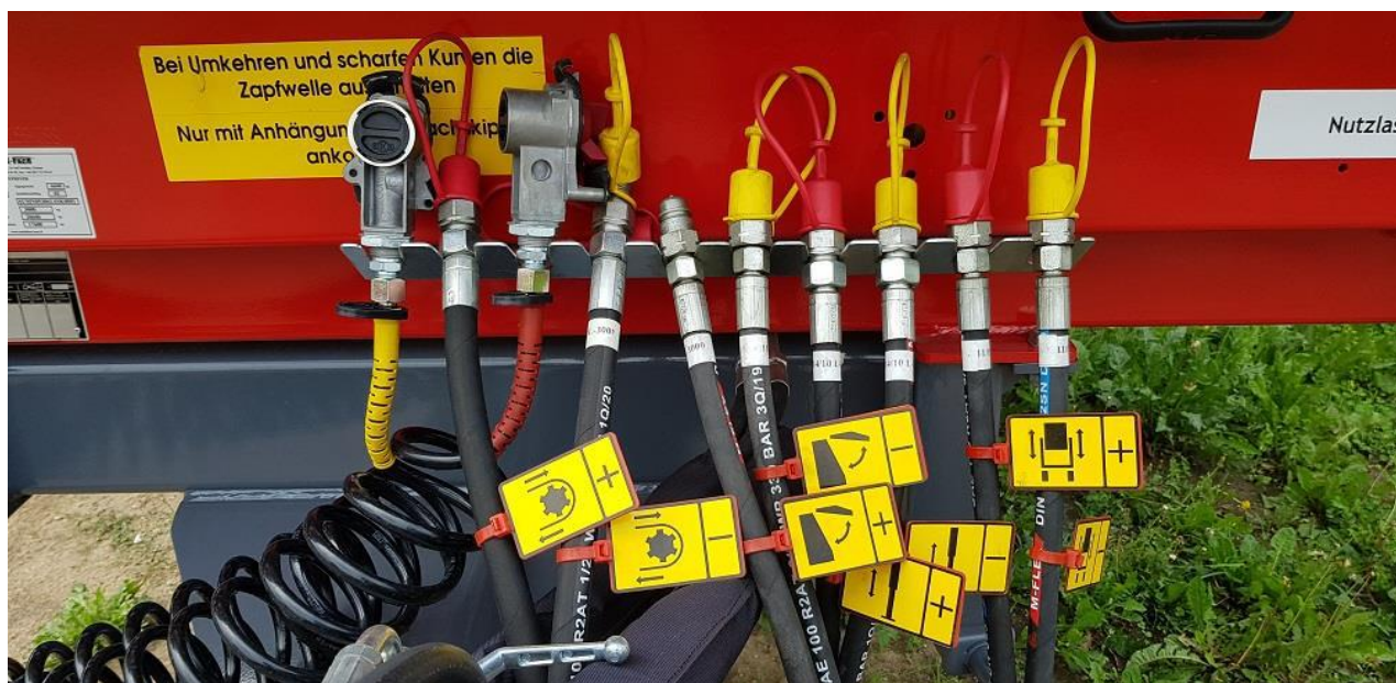
Rysunek 21. Oznaczenie złączy przewodów hydraulicznych piktogramami ułatwiającymi podłączenie przewodu do ciągnika (standard)przewodu do ciągnika – hydraulika bez rozdzielacza.
