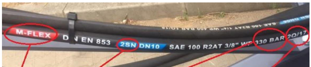
Producent Typ przewodu Maxymalne ciśnienie Data produkcji (w tym przypadku - 2 kwartał 2017)
