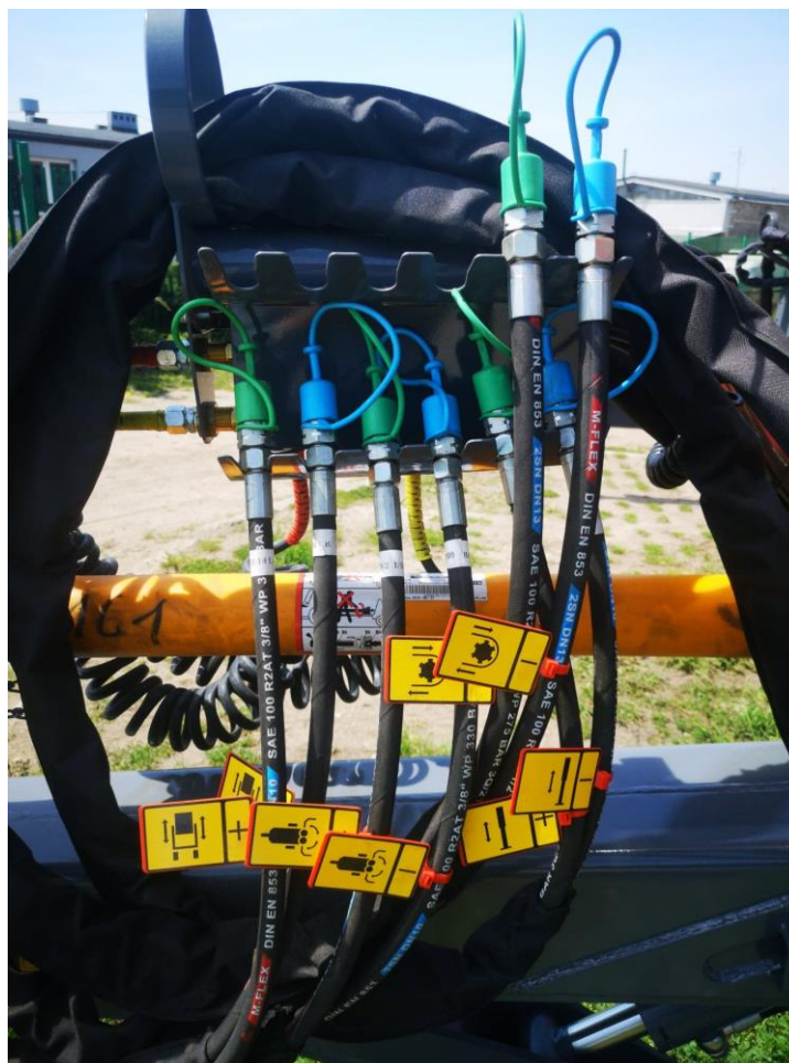
Rysunek 26. Oznaczenie złączy przewodów hydraulicznych piktogramami ułatwiającymi podłączenie przewodu do ciągnika (standard)
