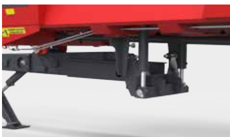
Dyszel amortyzowany hydraulicznie - pozwala na komfortowe wypoziomywanie maszyny
