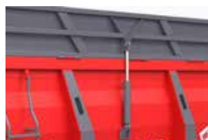
La rehausse hydraulique peut être abaissée et relevée. Contrôlé depuis la cabine du tracteur
