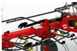
Réglage de l'angle de travail – Réglage mécanique de l'angle de travail pour un positionnement précis des dents
