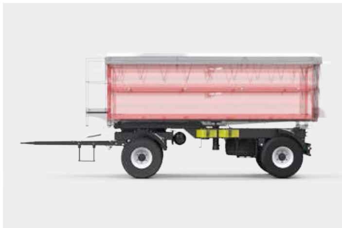
Un châssis à deux essieux est utilisé afin qu'aucune charge supplémentaire ne soit transférée au tracteur
