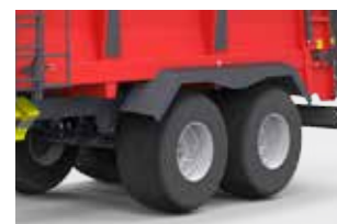
Épandeur tandem à deux essieux monté sur ressort pour un plus grand confort de conduite et une plus grande sécurité
