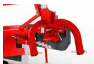
Cadre de suspension – Fabriqué à partir d'un seul profilé plié (carré – fermé).
