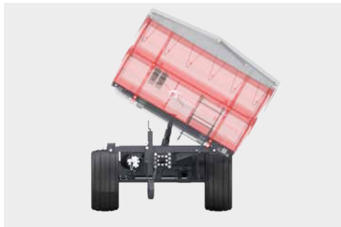
Basculement à trois voies 35/35° (arrière/latéral)
