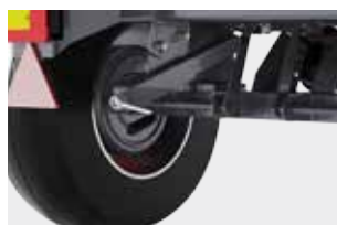
Frein de stationnement à main avec manivelle
