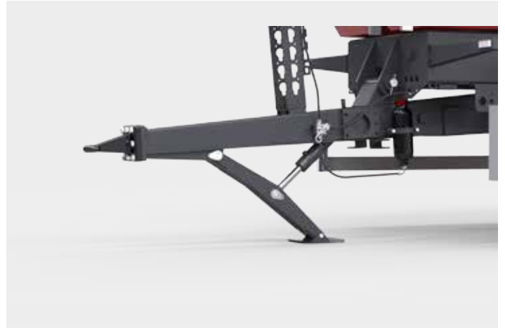
Pied de type ciseaux à commande hydraulique
