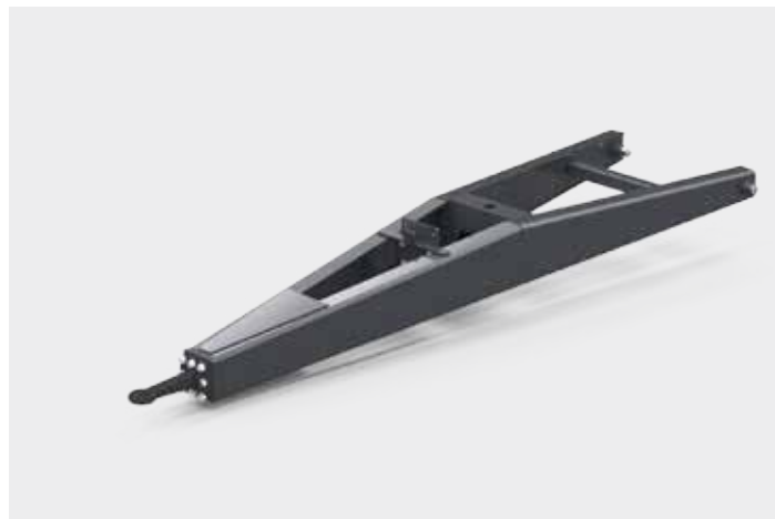
Timon avec adaptateur d'attelage - Anneau Ø 40 mm
