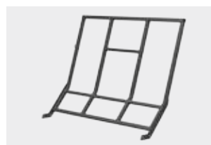
La forme modifiée du mur permet d'augmenter le nombre de balles chargées.
