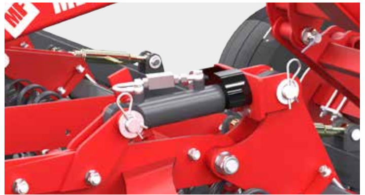
Réglage hydraulique de la profondeur de travail – assure un réglage précis
