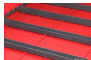
Plancher à entraînement hydraulique et à vitesse variable
