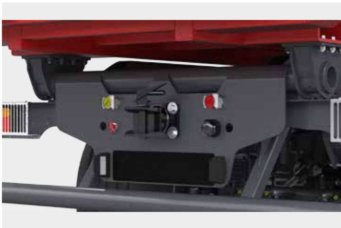
Prise média (connexion électrique, pneumatique et hydraulique)
