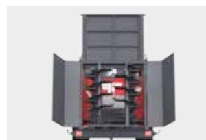
Paroi arrière relevée hydrauliquement, scellée au fond par une bande de caoutchouc
