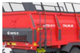
Échelle extérieure pliante + échelle intérieure amovible
