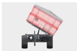
Basculement à trois voies 35/35°(arrière/latéral)
