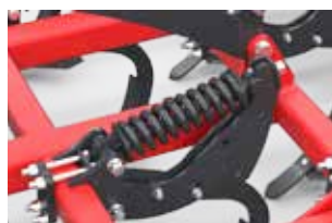
Protection des vis – protection des éléments de travail contre les surcharges
