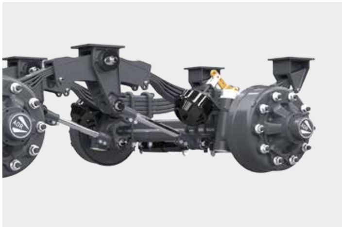
Подвеска TANDEM на листовой рессоре - Ось торсионная пассивная - прицепная
