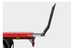
В новой платформе для рулонов выдвигание рамы увеличено с 800 мм до 1000 мм.
