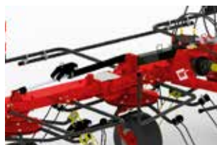
Регулировка угла работы - Механическая регулировка угла работы, позволяющая точно выставить положение зубьев
