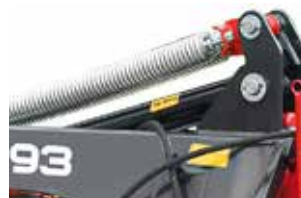
Гидравлический цилиндр Облегчает маневрирование и транспортировку машины. Одностороннего действия.
