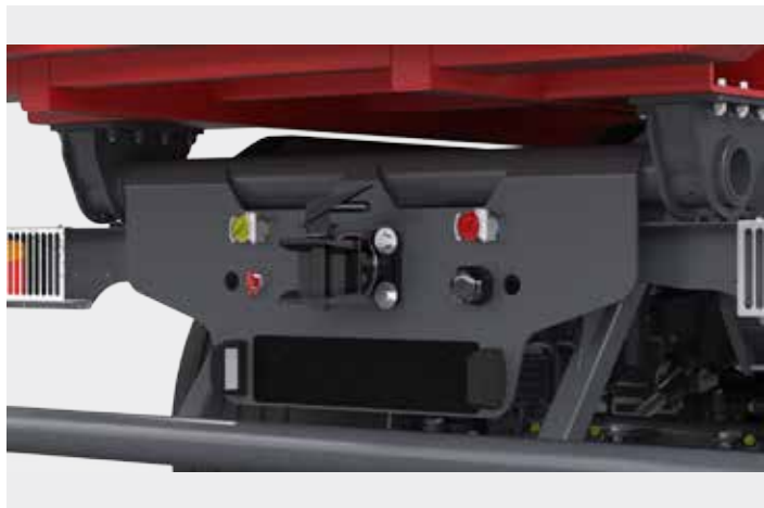
Медиа выходы (электрическое, пневматическое и гидравлическое соединение)
