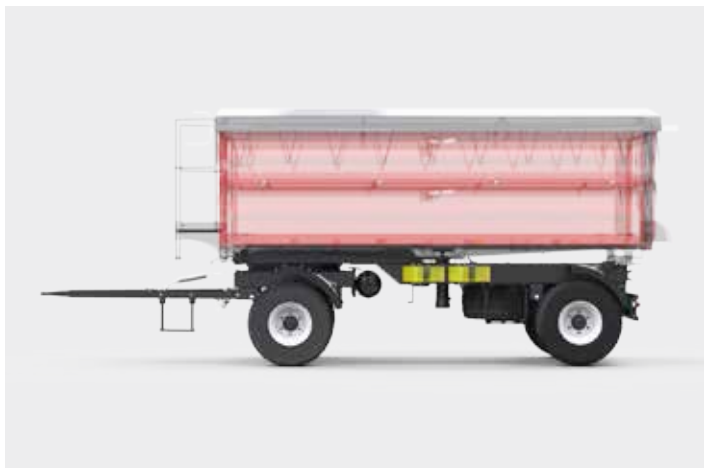
Используется двухосное шасси, поэтому на трактор не передаются дополнительные нагрузки
