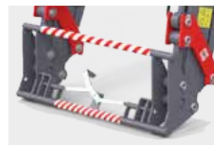
Крепление навесного оборудования - евро-рама
