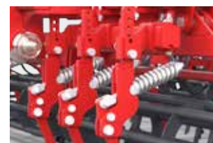
Пружинная защита зубьев
