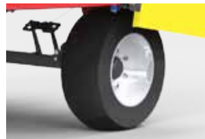
Шины Delcora - усиленные 30/11,5 14,5
