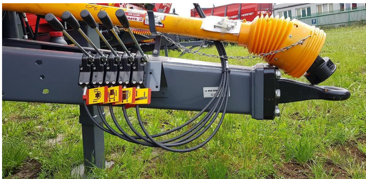
Рисунок 22 Пиктограммы, обозначающие рычаги управления распределителем (управление распределителем предлагается в качестве опции).
