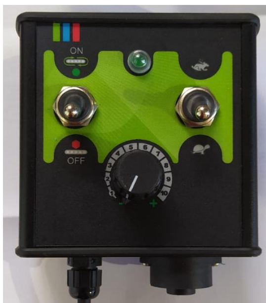
Рисунок 23 Панель управления для регулировки скорости перемещения напольного конвейера.
