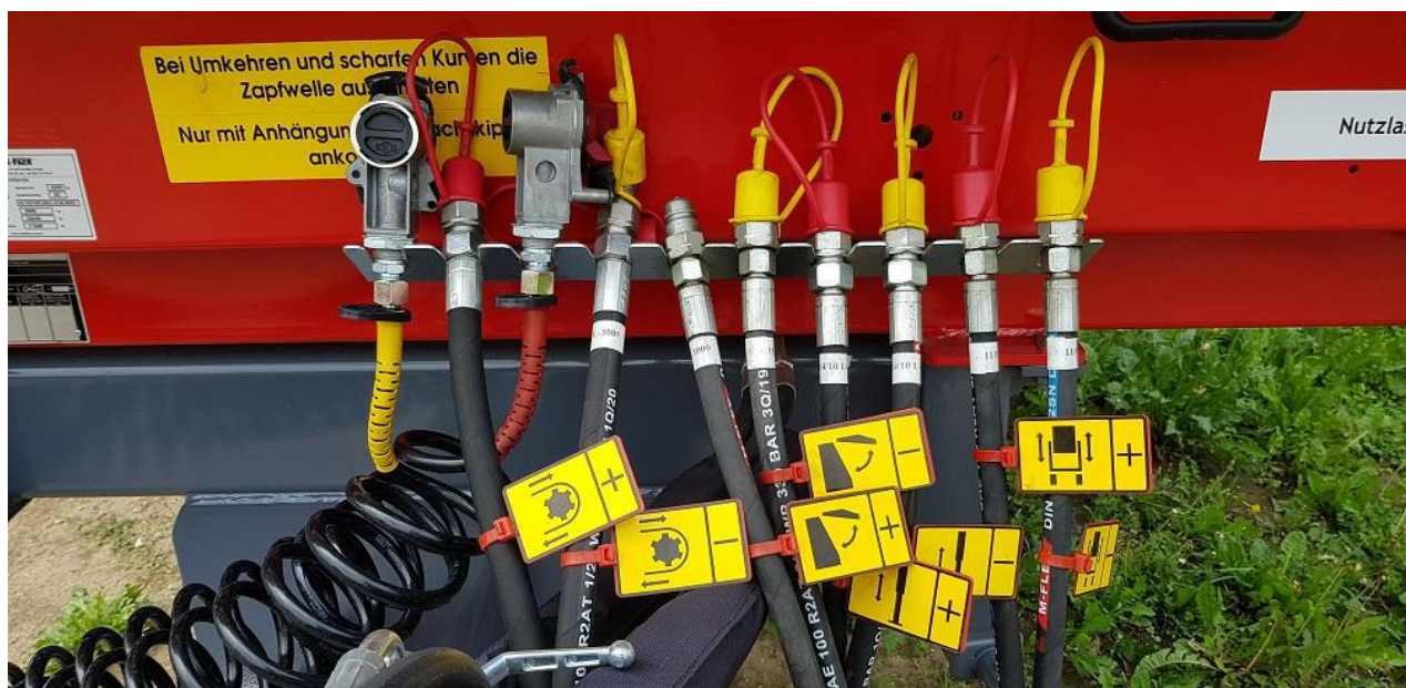
Рисунок 21 Маркировка соединений гидравлических шлангов пиктограммами для облегчения подключения шланга к трактору (стандарт) шланга к трактору - гидравлика без распределителя.
