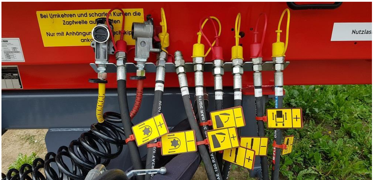
Figure 21 Marquage des raccords des conduites hydrauliques avec pictogrammes pour faciliter la connexion du tuyau au tracteur (standard) – système hydraulique sans répartiteur.
