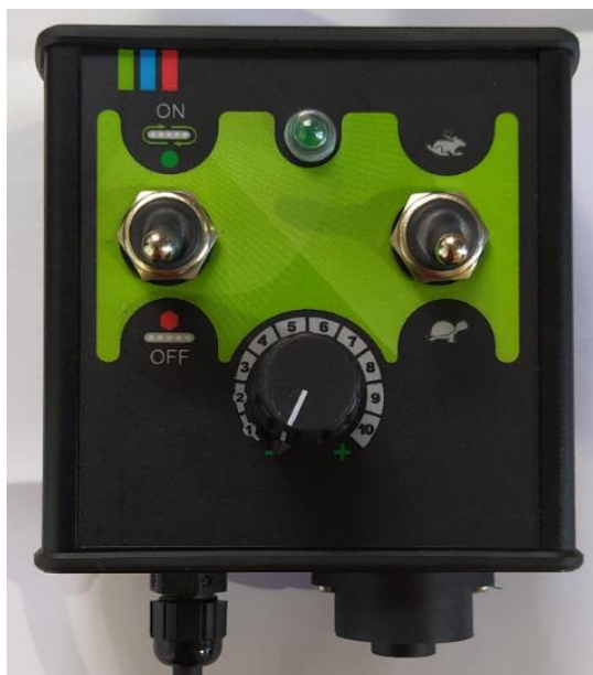
Figure 23 Panneau de commande pour le réglage de la vitesse du fond mouvant.
