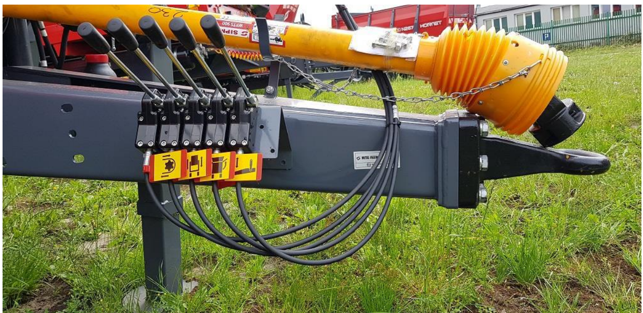
Figure 22 Marquage par pictogramme des leviers de commande du répartiteur (la commande du répartiteur est disponible en option).
