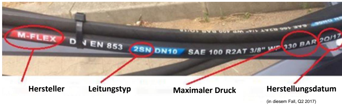
Abbildung 25. Kennzeichnung der Hydraulikleitungen
