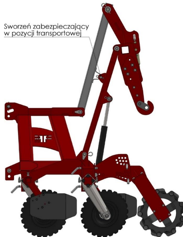
Rysunek 12. Sposób zabezpieczenia agregatu w pozycji transportowej
