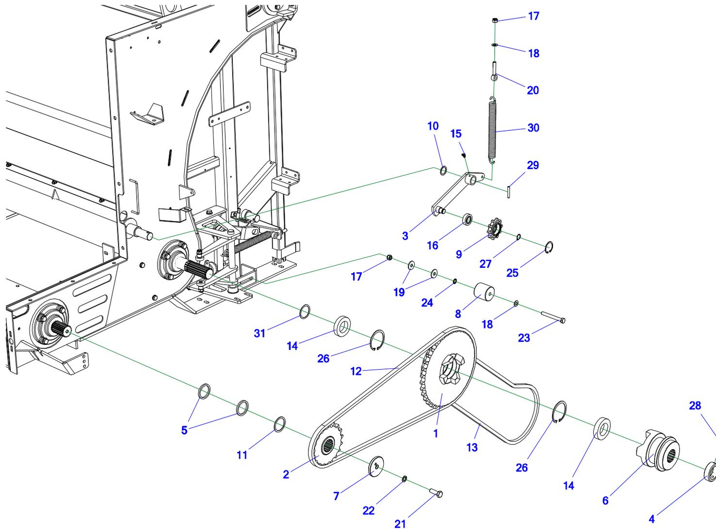
**Tabela 7. Przekładnie oraz sprzęgło złączające przenośnik łańcuchowo-prętowy cz. 1**
