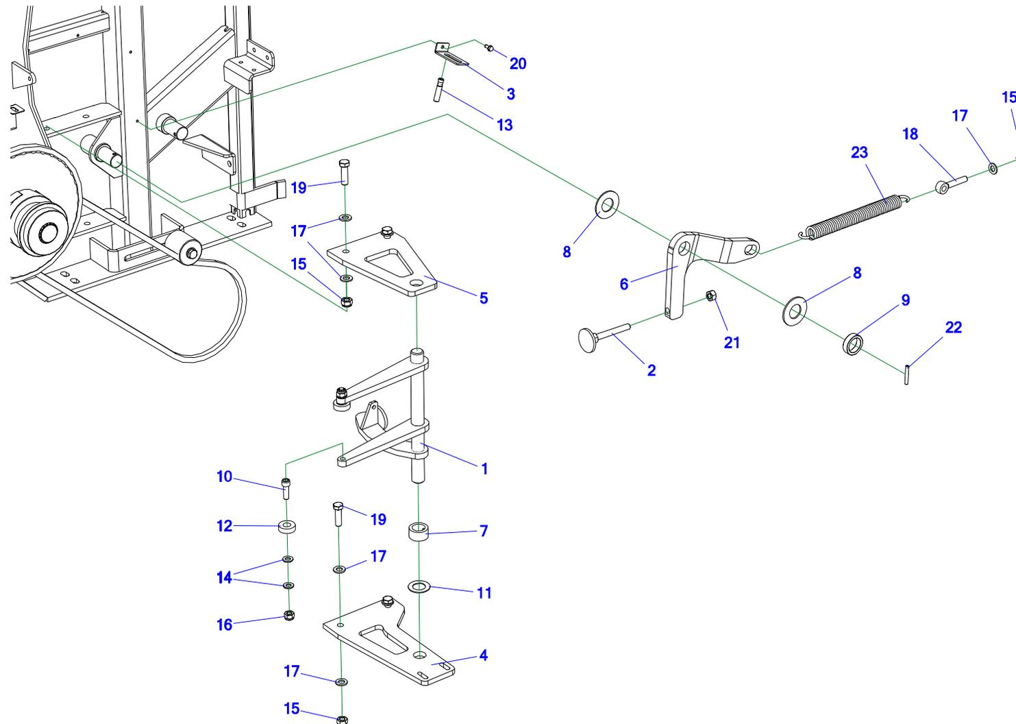
**Tabela 8. Przekładnie oraz sprzęgło złączające przenośnik łańcuchowo-prętowy cz. 2**
