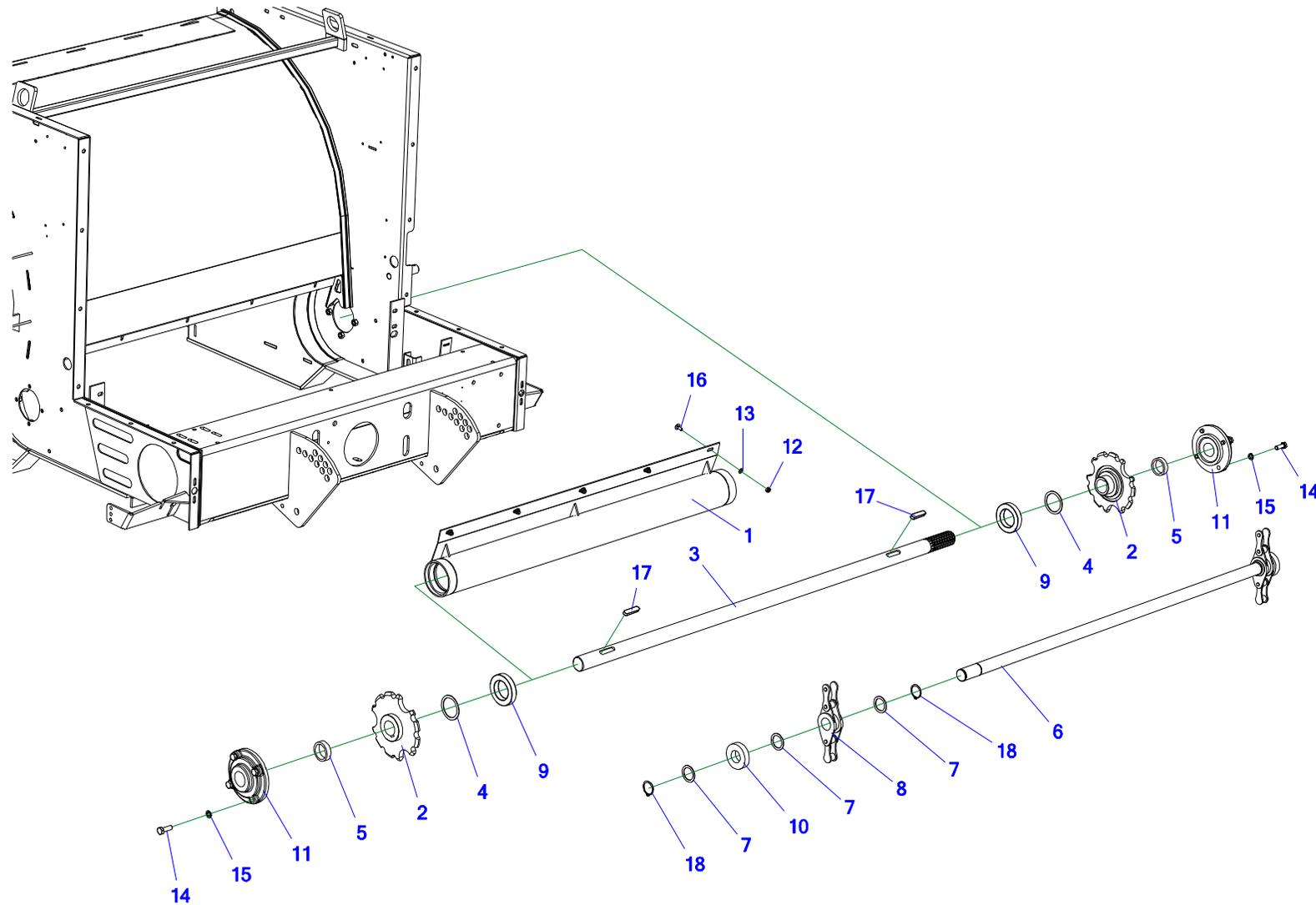
**Tabela 9. Przenośnik łańcuchowo-prętowy – wał napędowy**
