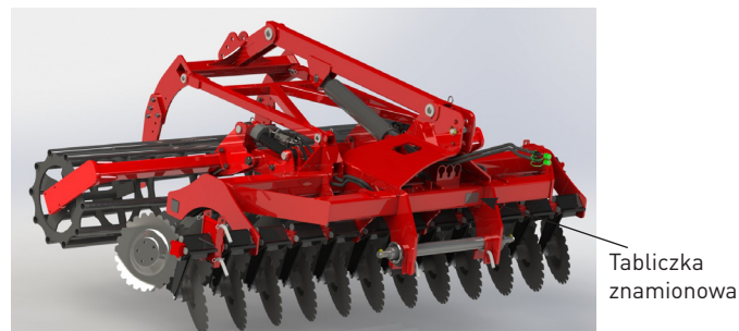
Rys. 2. Miejsce umieszczenia tabliczki znamionowej na maszynie
