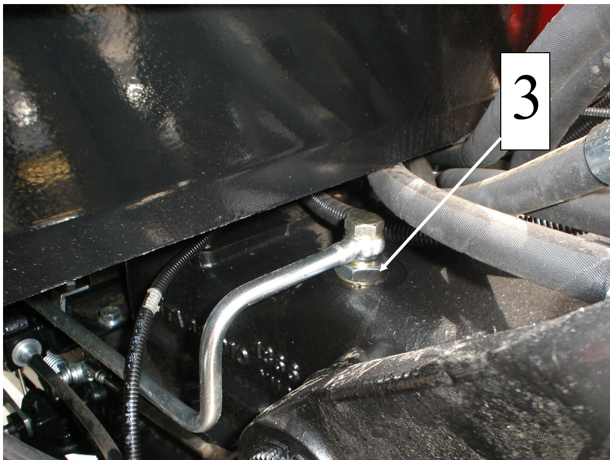
Rys. 4. Miejsce podłączenia wolnego spływu. (widok z tyłu ciągnika z lewej strony za gniazdami przyłączeniowymi)
