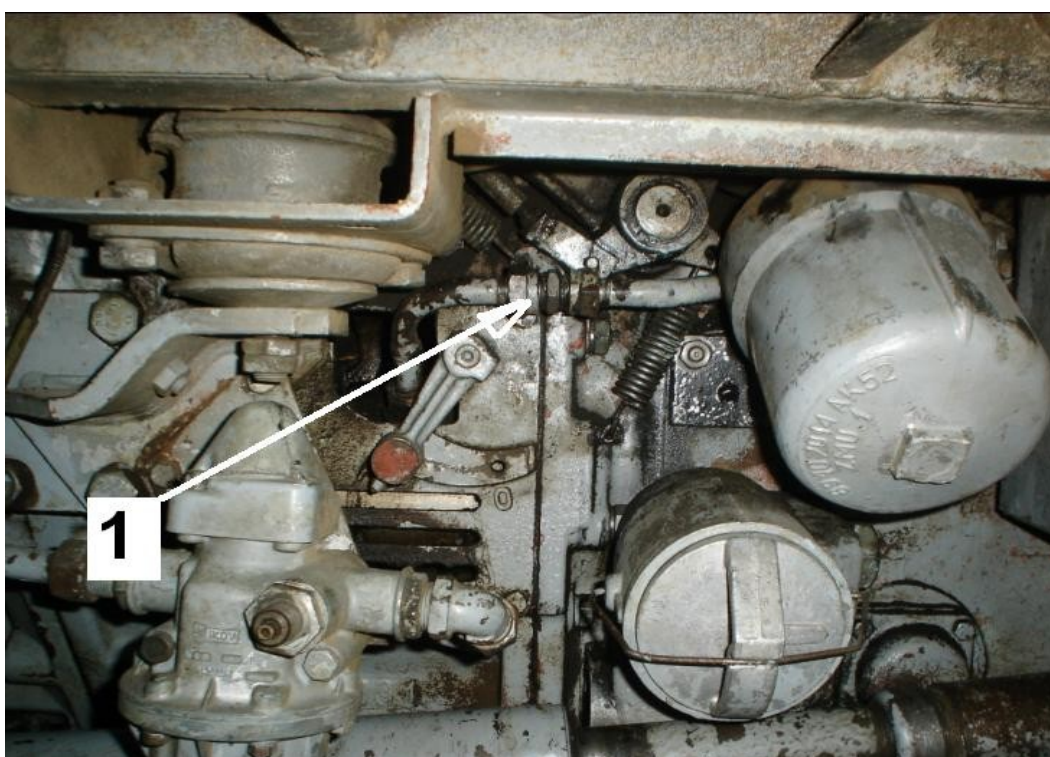
Rys. 2. Miejsce rozpięcia instalacji ciągnika i podłączenia zasilania rozdzielacza ładowacza
