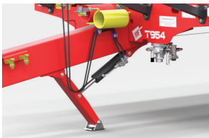
Hydrauliczna stopka podporowowa nożycowa
