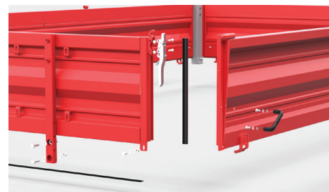
Przycepy posiadają specjalne uszczelki które zapewniają odpowiednią szczelność
