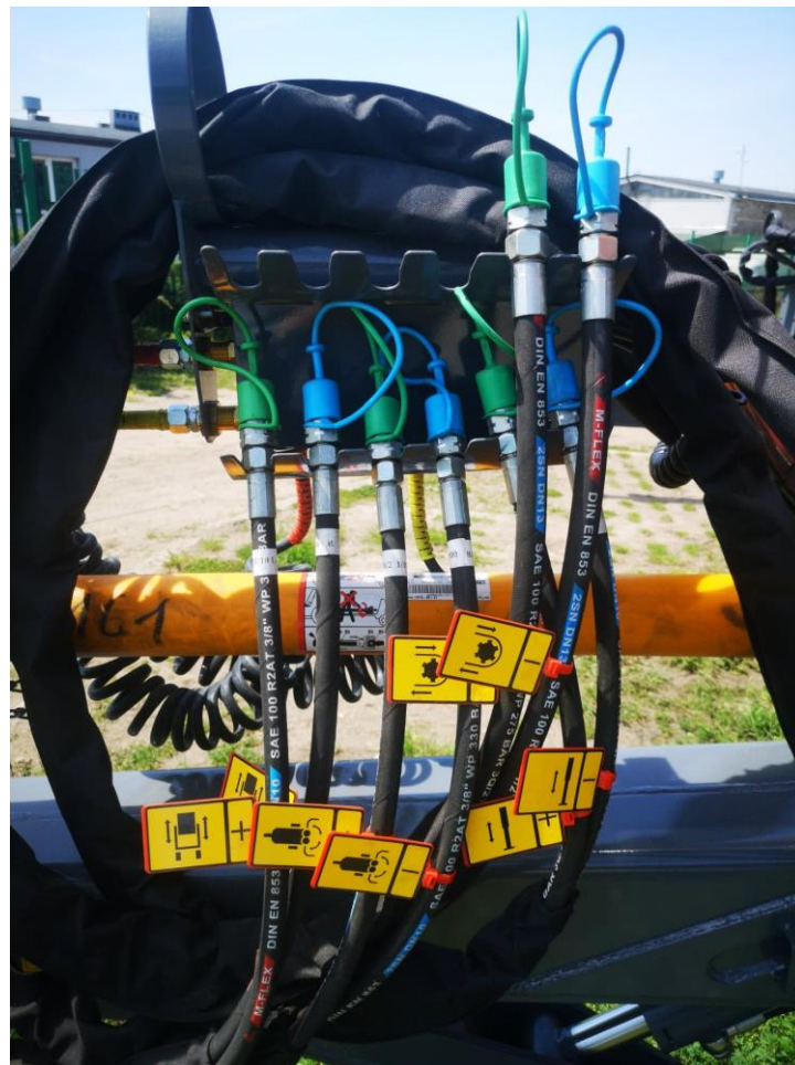
Рисунок 26. Пиктограммы на разъемах гидравлических линий для облегчения подключения линии к трактору (стандарт)
