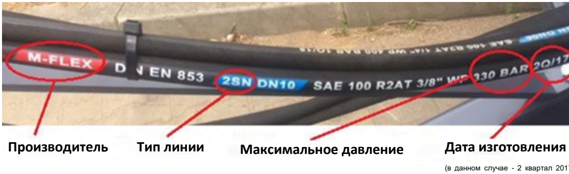
Рисунок 25. Обозначение гидравлических линий
