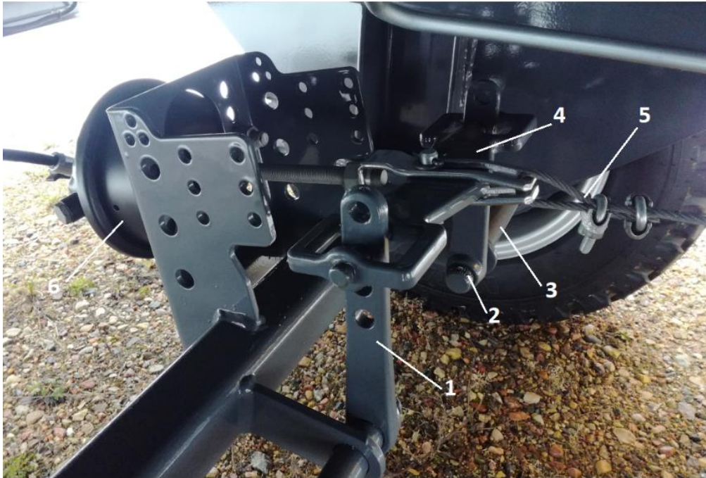
Abbildung 19. Elemente der Bremsanlage: 1 - Hebel der Spreizschlosswelle, 2 - Stellkamm, 3 - Spreizschlosswelle, 4 - Bremsbügel, 5 - Seil der Feststellbremse, 6 – Stellantrieb
