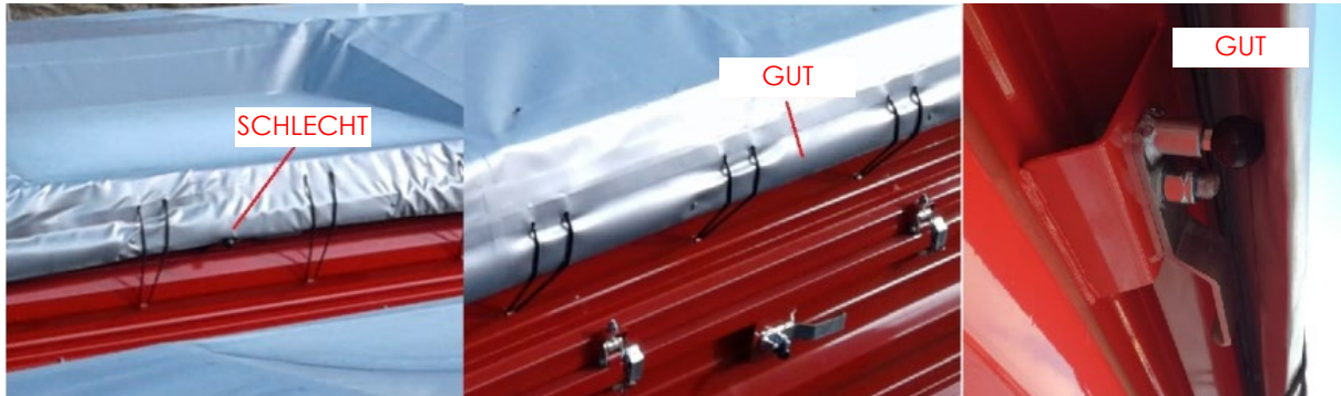
Abbildung 3. Richtige Spannung der Plane
