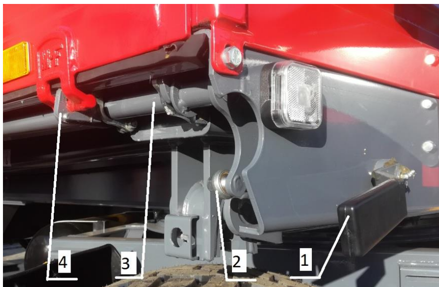
Abbildung 19. Schlösser der Wände des Ladekastens: 1 zentraler Hebel der unteren Schlösser, 2-Schloss-Einstellmechanismus, 3 - zentrale Schlosswelle, 4 - Schloss
